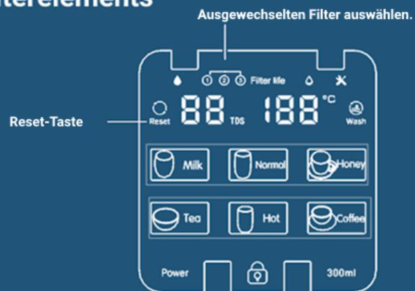
Halten Sie „Reset“ bis zum Aufleuchten von „Filter life“ gedrückt. Tippen Sie danach erneut auf „Reset“ und wählen Sie die Nummer des jeweils gewechselten Filters durch erneutes Tippen der „Reset“-Taste. Beenden Sie den Vorgang durch 3-sekündiges Halten der „Reset“-Taste.
